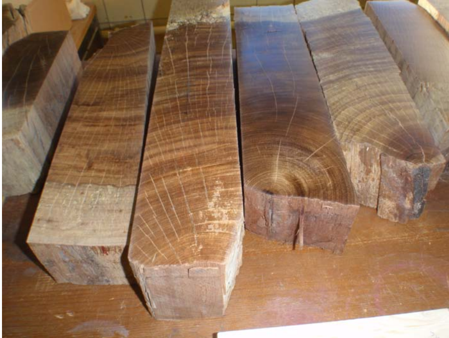
FIGURE 16 – Barreaux après ponçage
