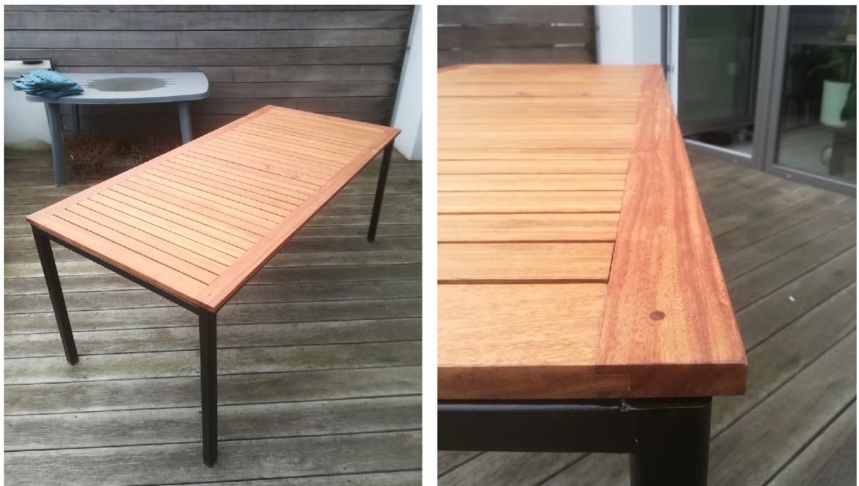
Figure 25 : Table extérieur en Dialium polyanthum selon une mise en œuvre appropriée. Seules des pièces sur quartier/faux quartier ont été utilisées. Les traverses intérieures sont espacées et uniquement vissées dans la rainure du montant pour laisser le retrait radial s'exprimer (Namur, Belgique).
