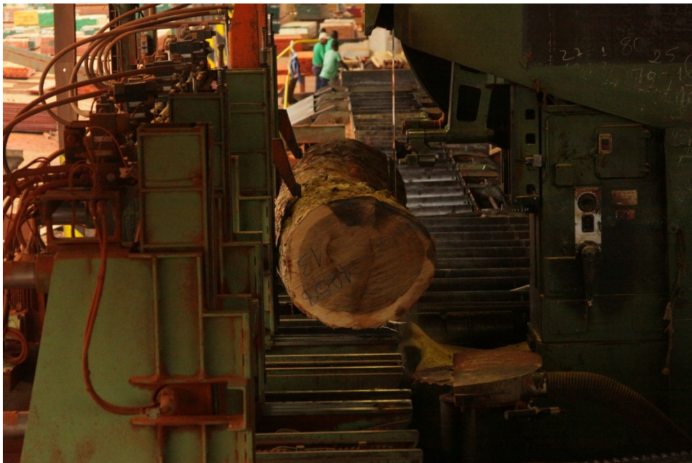
Figure 31 : Découpe d'un courçon de Dialium lopense avec la lame au carbure du tungstène
