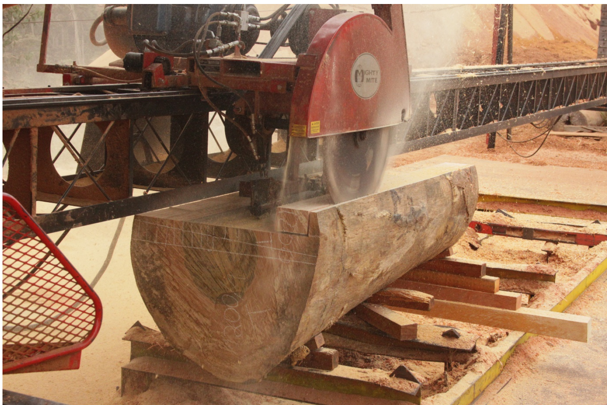
Figure 20 : Découpe d'un billon d'Eveuss pour la production de planches et de chevrons exportables vers le Laboratoire de Technologie du Bois en Belgique.
