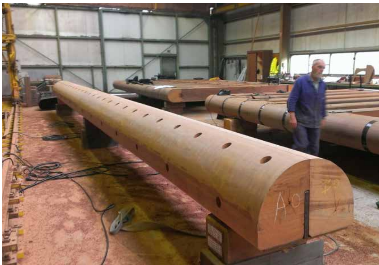
Pièces de portes d'écluses en Azobé (Société Wijma – Kampen – Pays-Bas)
