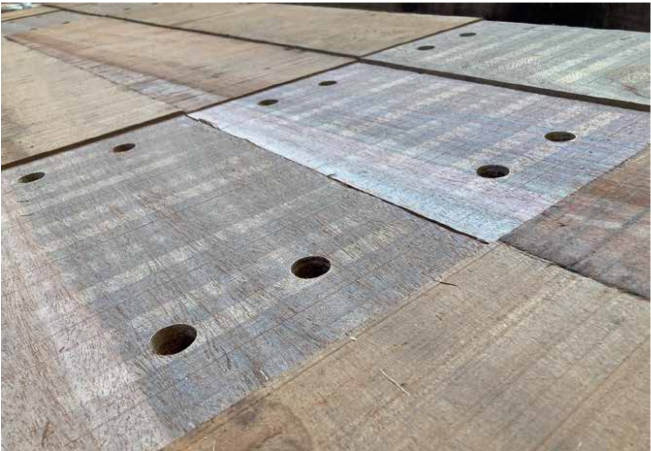
Préparation de traverses en Azobé (photo Emmanuel Groutel, WALE, Gabon)
