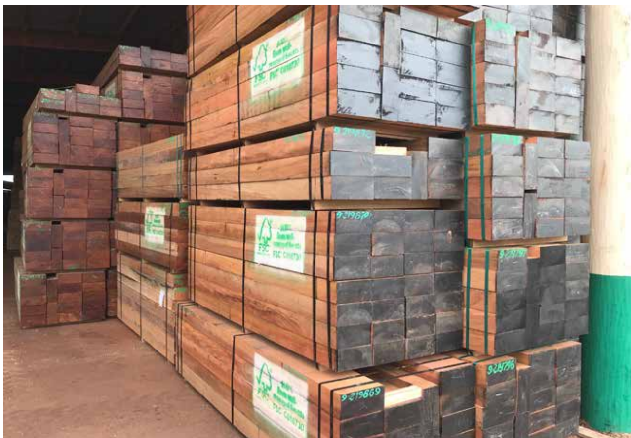
Traverses en Angelim et Angelim vermelho (au 2 nd plan) (photo Stéphane Glannaz, Mil Madeiras Preciosas Ltd - Precious Woods Amazonas, Itacuatira, Etat de Amazonas, Brésil)
