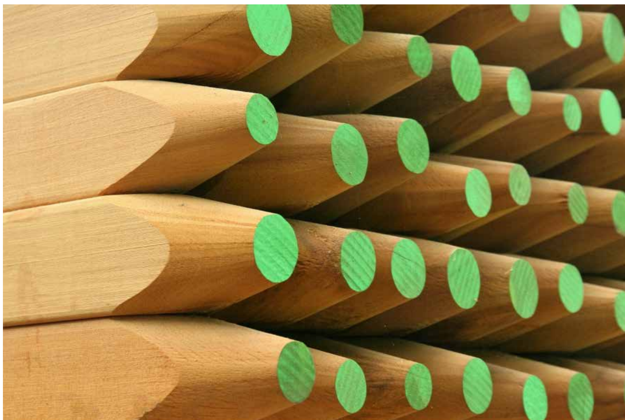
Pieux appointés en Niové pour aménagements hydrauliques aux Pays-Bas Compagnie des Bois du Gabon - Port-Gentil, Gabon (© Emmanuel Groutel, WALE)
