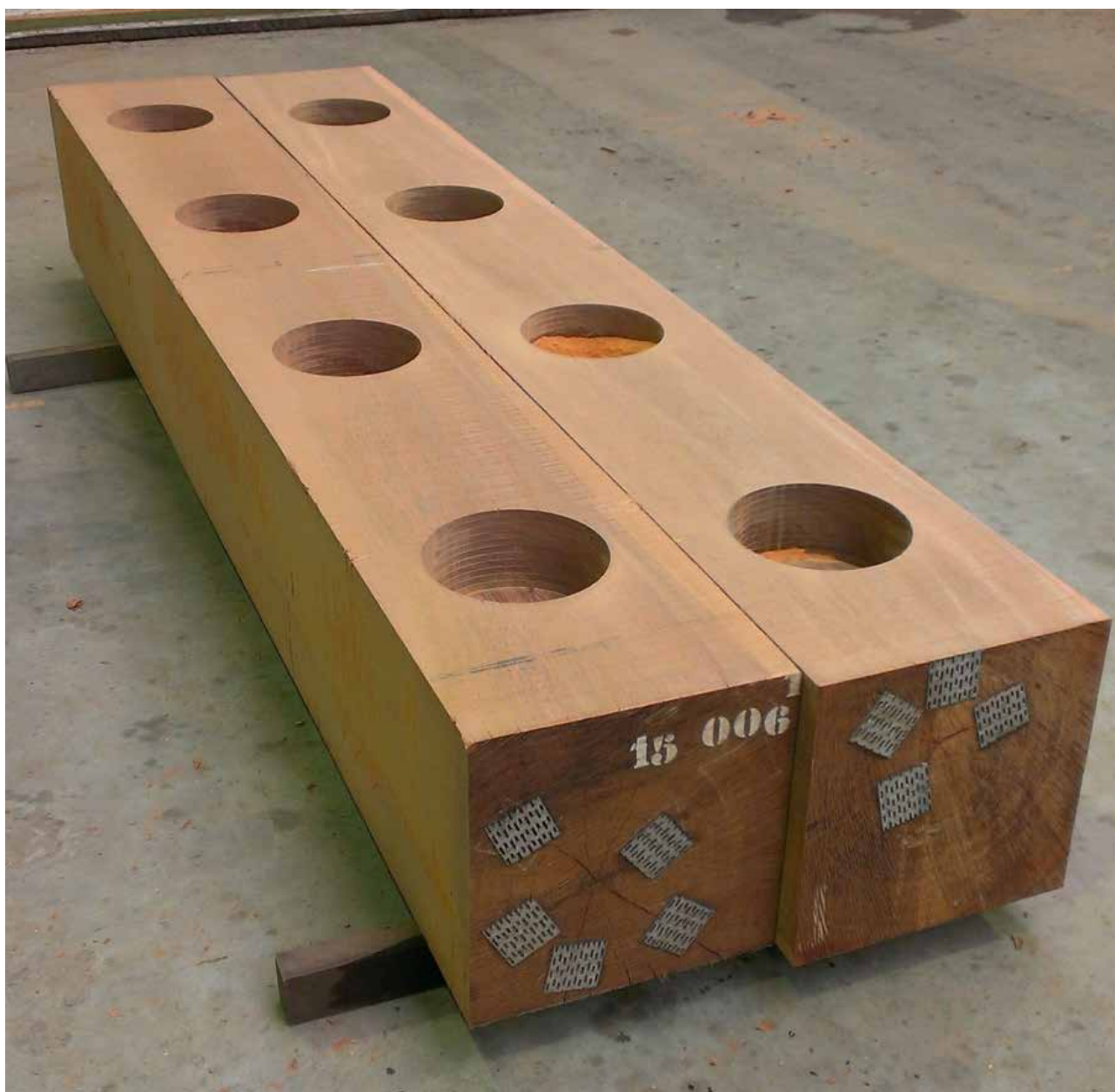
Pièces d'Azobé avec cœur enrobé pour la construction d'une défense spécifique (Société Wijma – Kampen – Pays-Bas)
