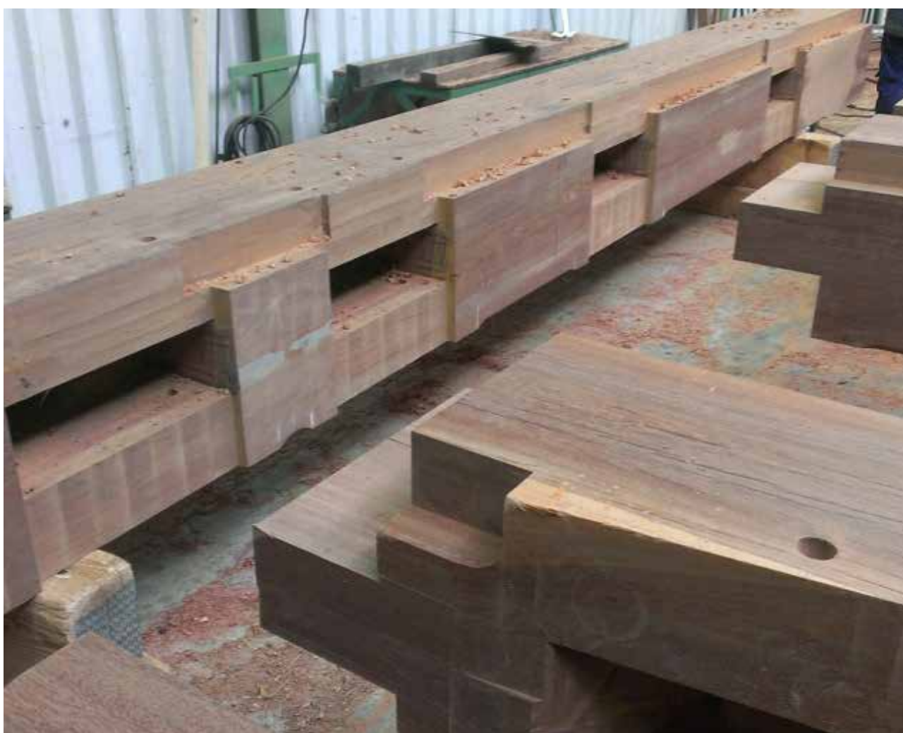
Fabrication de portes d'écluses en Azobé (Société Wijma – Kampen – Pays-Bas)
